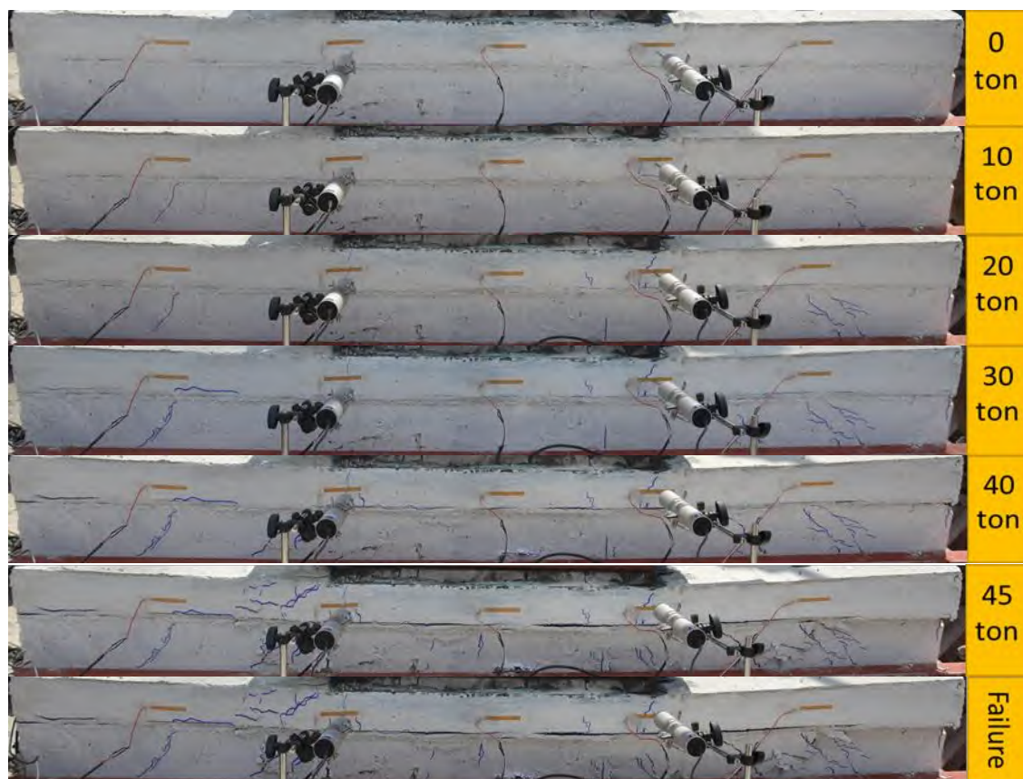
รูปที่ 4.2-15 รูปแบบการแตกร้าวของบ่ารองรับรอยต่อรูปแบบที่ 8 ตัวอย่างที่ 1 (B-08-SL-RP1)
