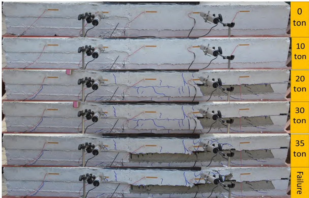
รูปที่ 4.2-16 รูปแบบการแตกร้าวของบารองรับรอยต่อรูปแบบที่ 8 ตัวอย่างที่ 2 (B-08-SL-RP2)
