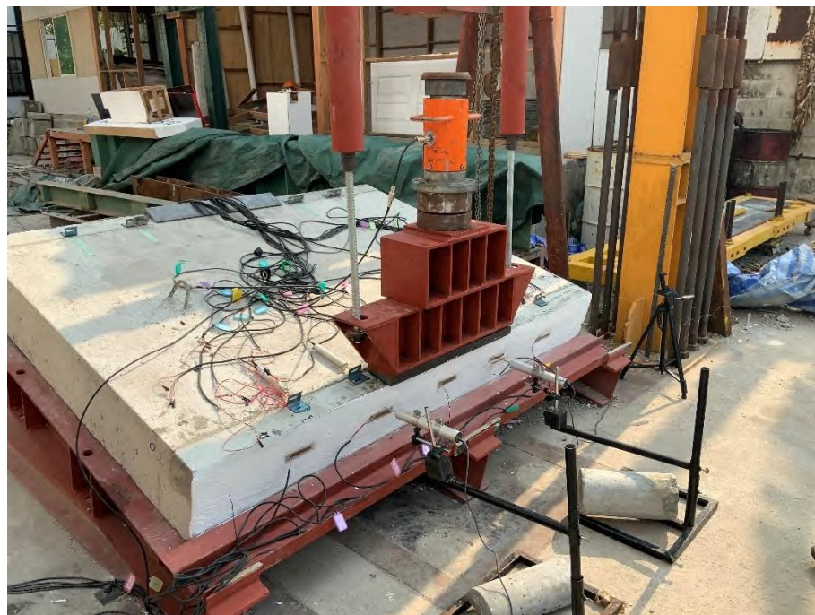
รูปที่ 3.1-5 การเตรียมการทดสอบรอยต่อพื้นสะพาน (Test Setup)
