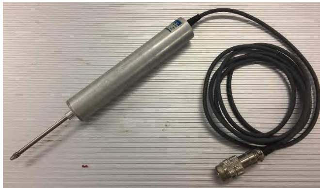
รูปที่ 3.1-6 อุปกรณ์วัดการเคลื่อนตัว (Displacement Transducer)
