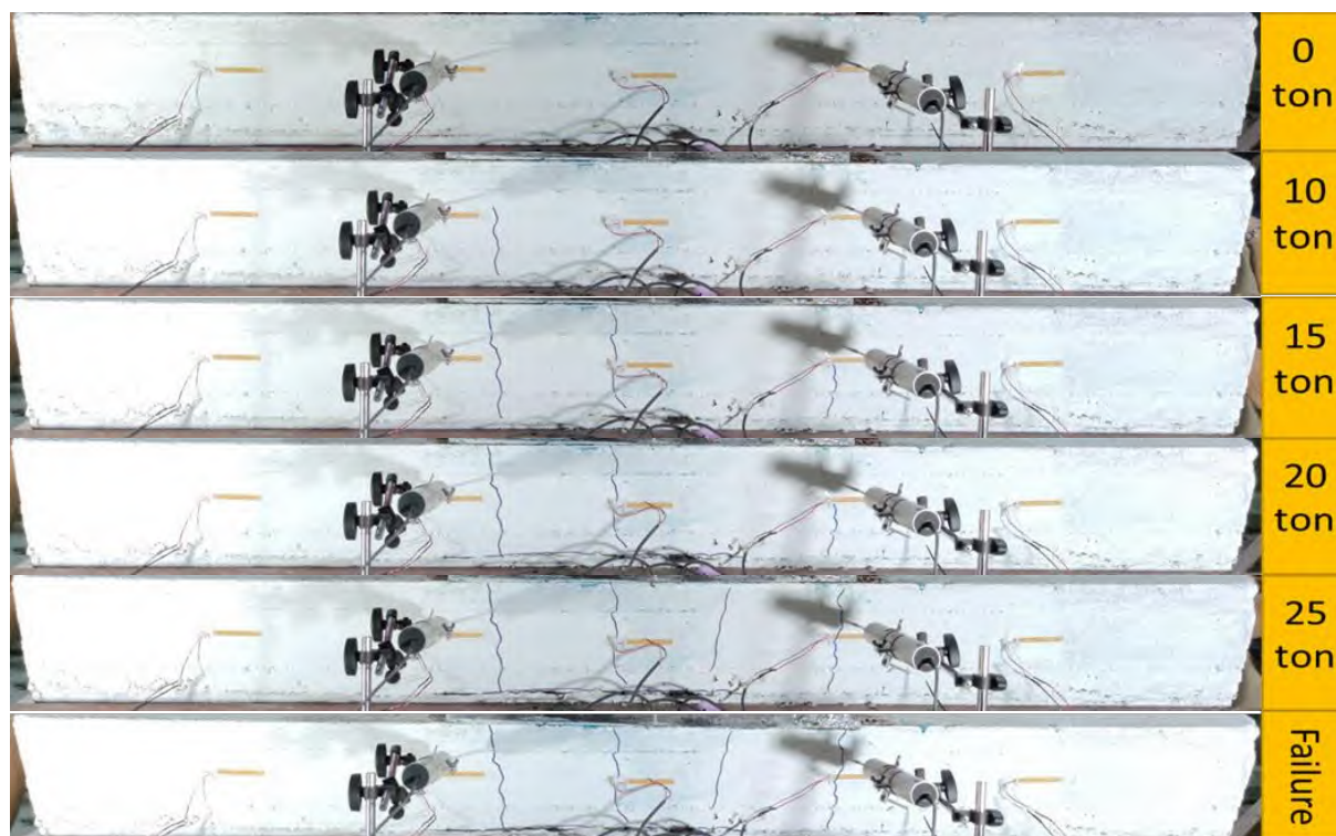
รูปที่ 4.2-72 รูปแบบการแตกร้าวของบ่ารองรับรอยต่อรูปแบบที่ 12 ตัวอย่างที่ 1 (B-12-SL-RP1)
