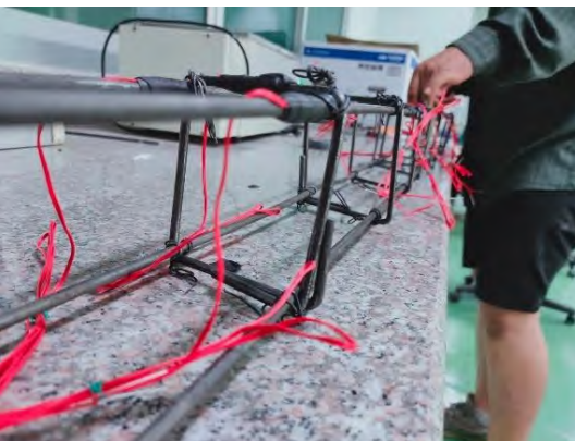
รูปที่ 3.1-20 การติดตั้งแถววัดความเครียดในเหล็กเสริม
