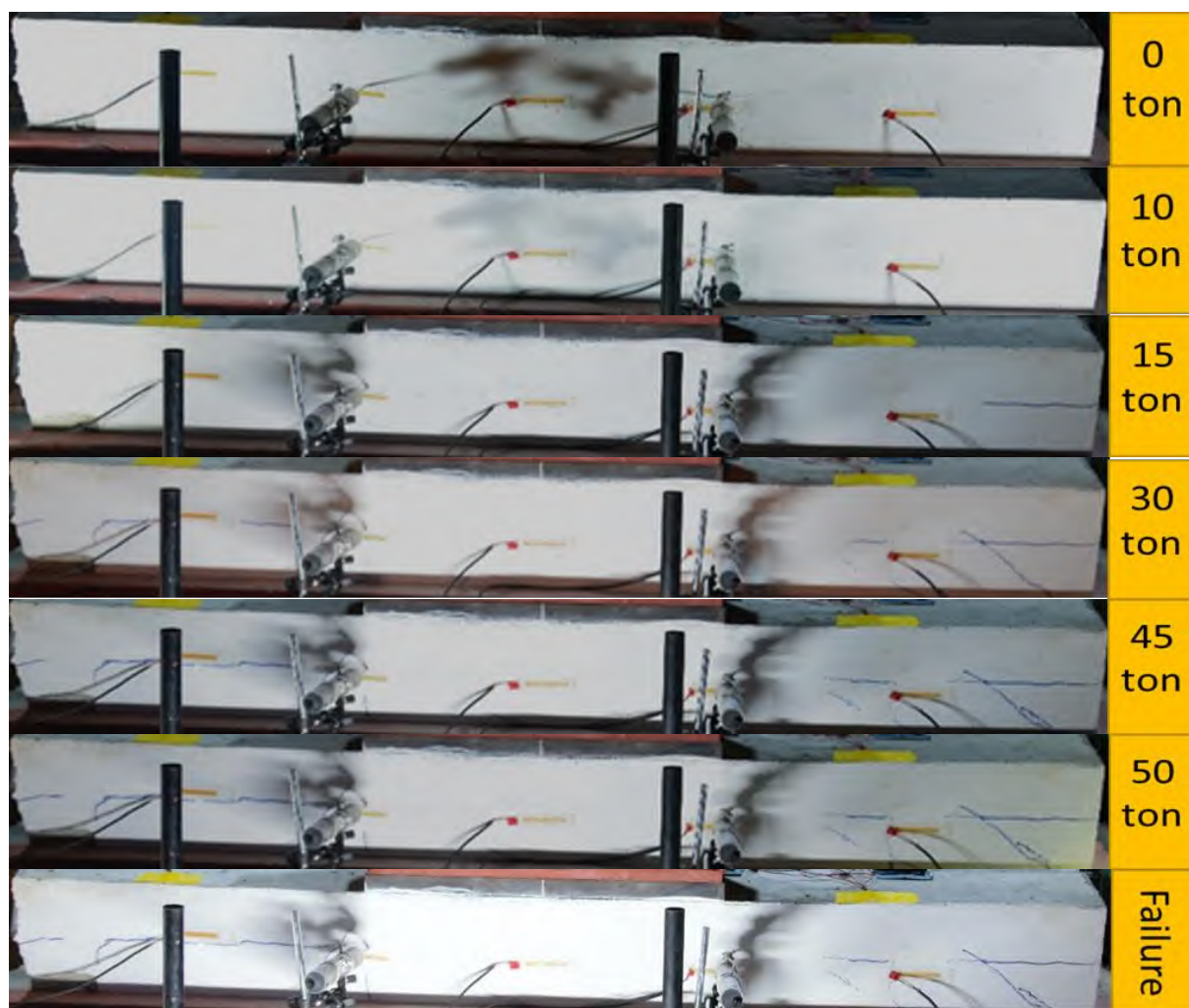
รูปที่ 4.1-15 รูปแบบการแตกร้าวของบ่มองรับรอยต่อรูปแบบที่ 2 ตัวอย่างที่ 1 (B-02-SL1)
