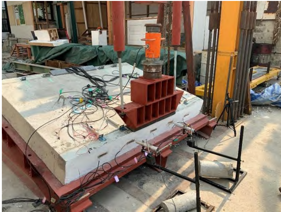
รูปที่ 4.3-6 การทดสอบบารองรับรอยต่อพื้นสะพานในห้องปฏิบัติการ
