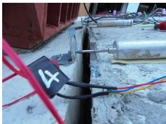
รูปที่ 3.1-22 การติดตั้งอุปกรณ์วัดการเคลื่อนที่หรือการเสียรูปของโครงสร้าง
