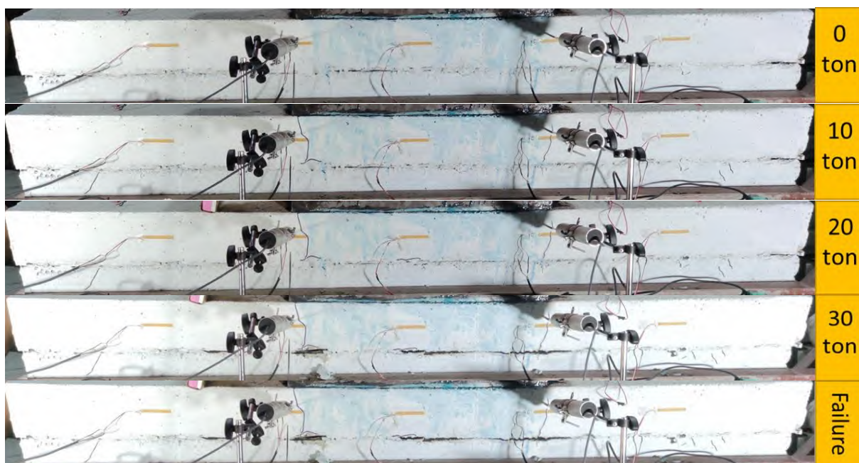
รูปที่ 4.2-57 รูปแบบการแตกร้าวของบารองรับรอยต่อรูปแบบที่ 11 ตัวอย่างที่ 1 (B-11-SL-RP1)
