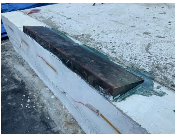
รูปที่ 3.1-21 การติดตั้งอุปกรณ์วัดความเครียดบนผิวคอนกรีต
