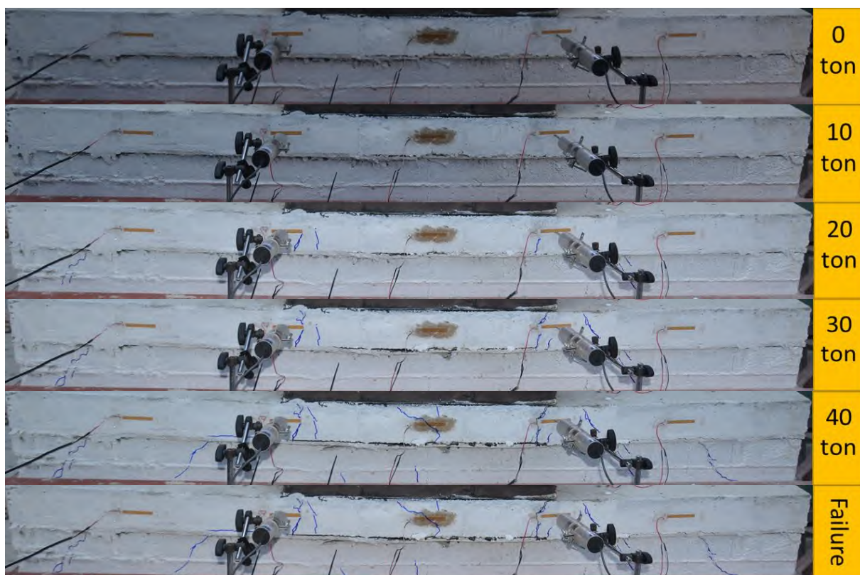
รูปที่ 4.2-30 รูปแบบการแตกร้าวของบ่ารองรับรอยต่อรูปแบบที่ 2 ตัวอย่างที่ 2 (B-09-SL-RP2)
