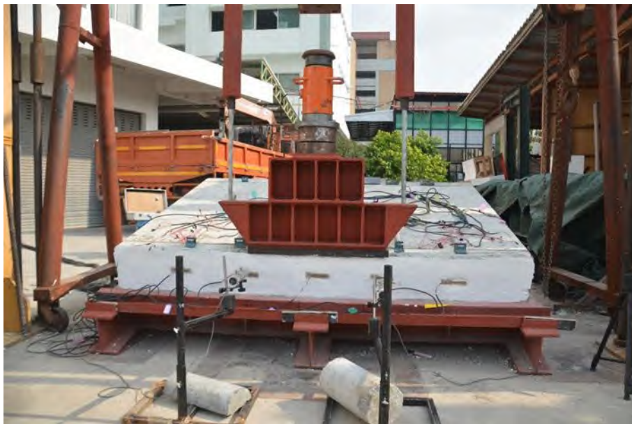
รูปที่ 3.1-24 ตัวอย่างการติดตั้งบ่ารองรับรอยต่อพื้นสะพานทดสอบบนฐานรองรับ
