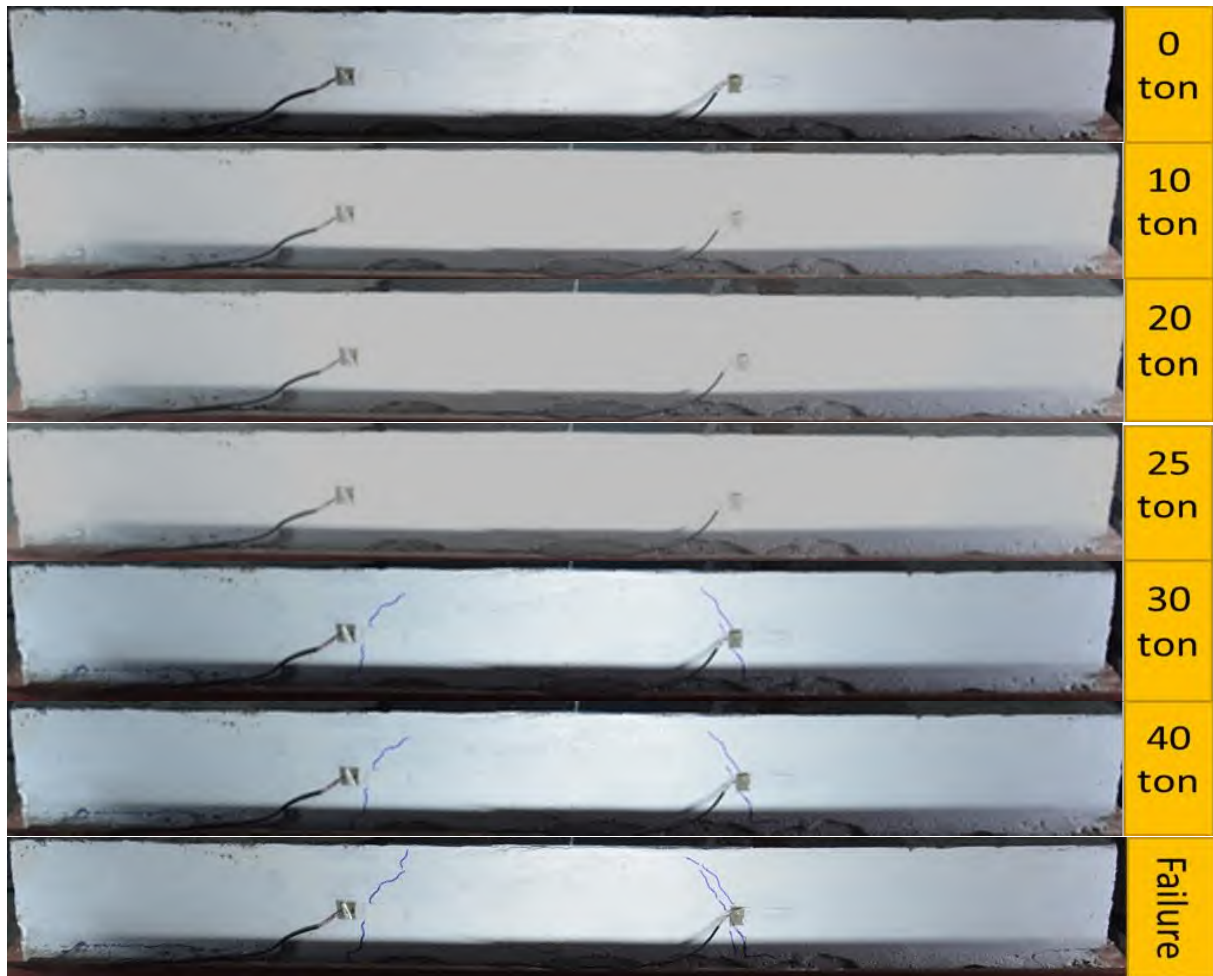
รูปที่ 4.1-72 รูปแบบการแตกร้าวของบ่ารองรับรอยต่อรูปแบบที่ 6 ตัวอย่างที่ 2 (B-06-SL2)
