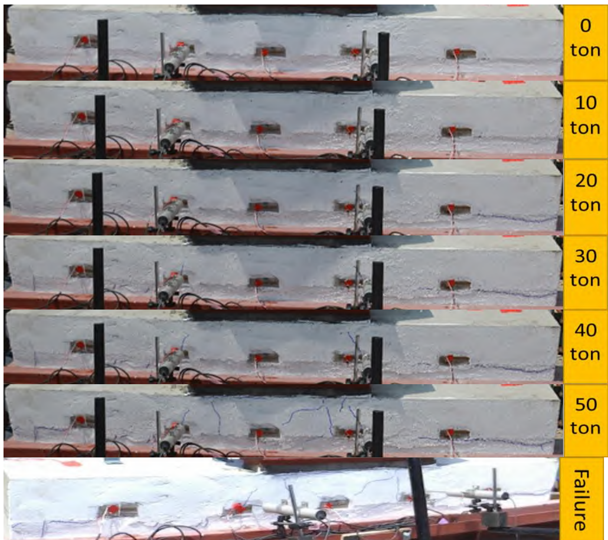
รูปที่ 4.1-58 รูปแบบการแตกร้าวของบ่ารองรับรอยต่อรูปแบบที่ 5 ตัวอย่างที่ 2 (B-05-SL2)
