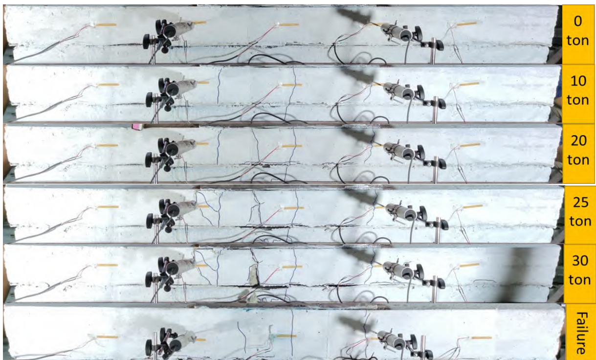
รูปที่ 4.2-58 รูปแบบการแตกร้าวของบ่ารองรับรอยต่อรูปแบบที่ 11 ตัวอย่างที่ 2 (B-11-SL-RP2)
