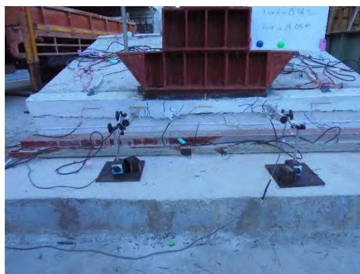
รูปที่ 3.1-22 การติดตั้งอุปกรณ์วัดการเคลื่อนที่หรือการเสียรูปของโครงสร้าง
