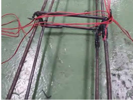
รูปที่ 3.1-20 การติดตั้งแถววัดความเครียดในเหล็กเสริม
